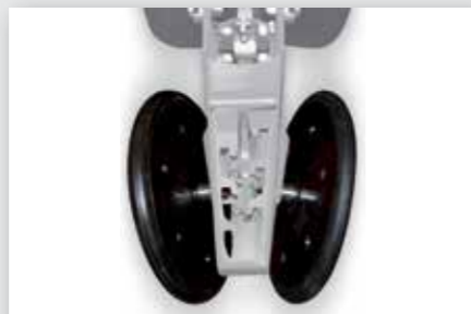
Резиновые колеса диаметром 12" шириной 1"
